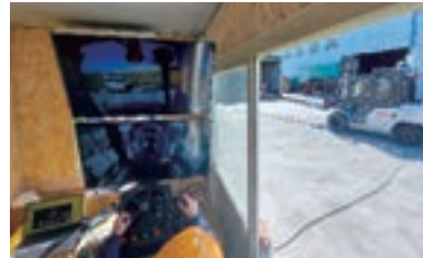
フォークリフトの遠隔操作
